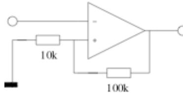
Abbildung 4: **Schmitt-Trigger Schaltbild**
